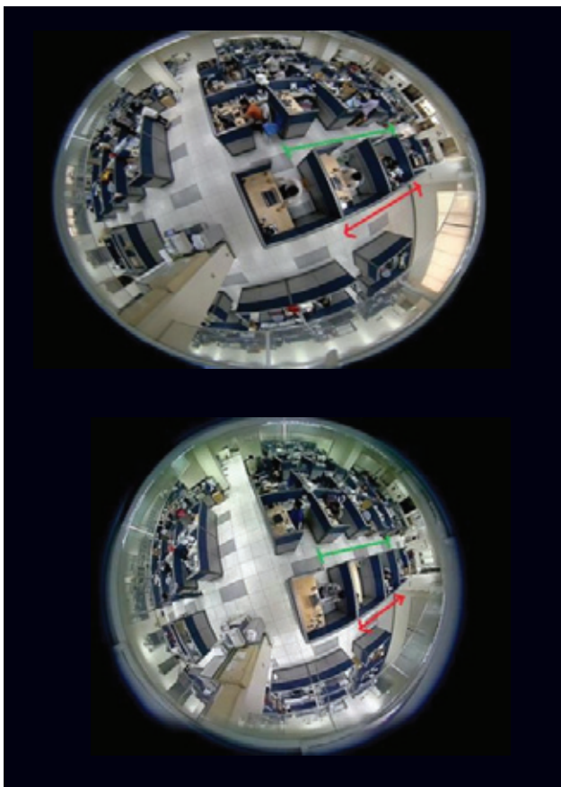
Объективы новых камер дают возможность получить эллиптическое изображение, тем самым позволяя оптимально использовать матрицу устройства
